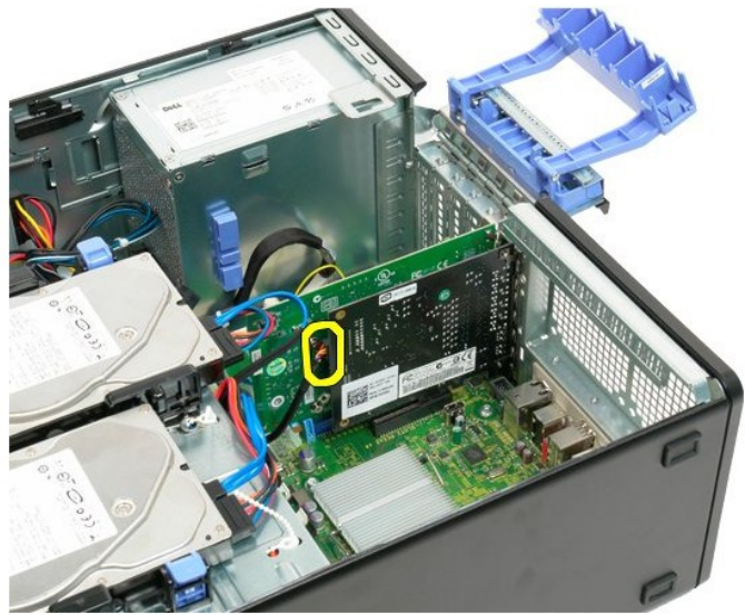
7. הרם את כרטיס ההרחבה והסר אותו מהמחשב.
