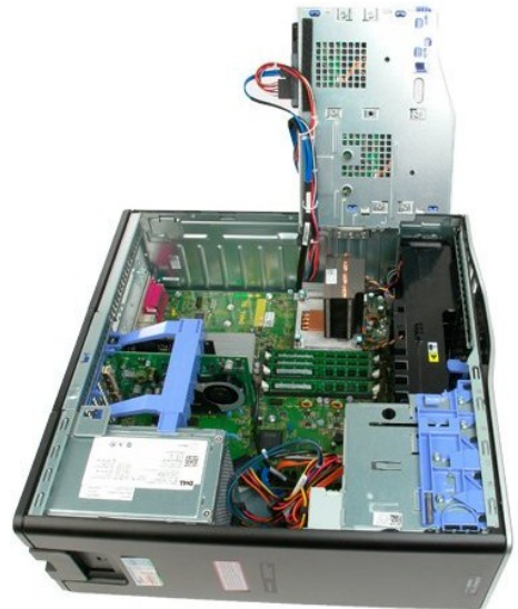
5. בעזרת אגודל'ר, לחץ בעדינות על תפסי החזקת מודול הזיכרון בשני צדדי המודול כדי לנתקו ממחבר לוח המערכת.
