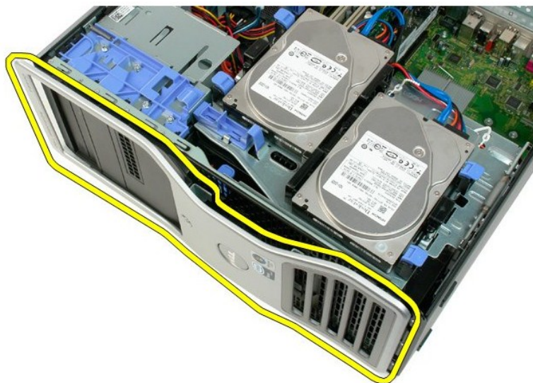
4. משוך את הכיסוי והרחק אותו מחדית המחשב.
